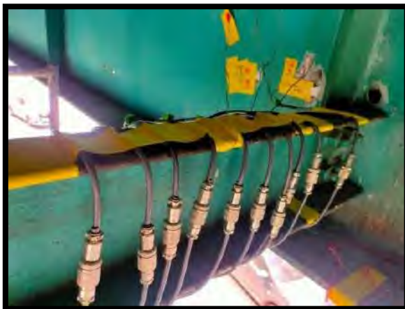
รูปที่ 5.7-3 ภาพการติดตั้งอุปกรณ์ตรวจวัดสะพานตัวที่ 1 (Flyover 1)
