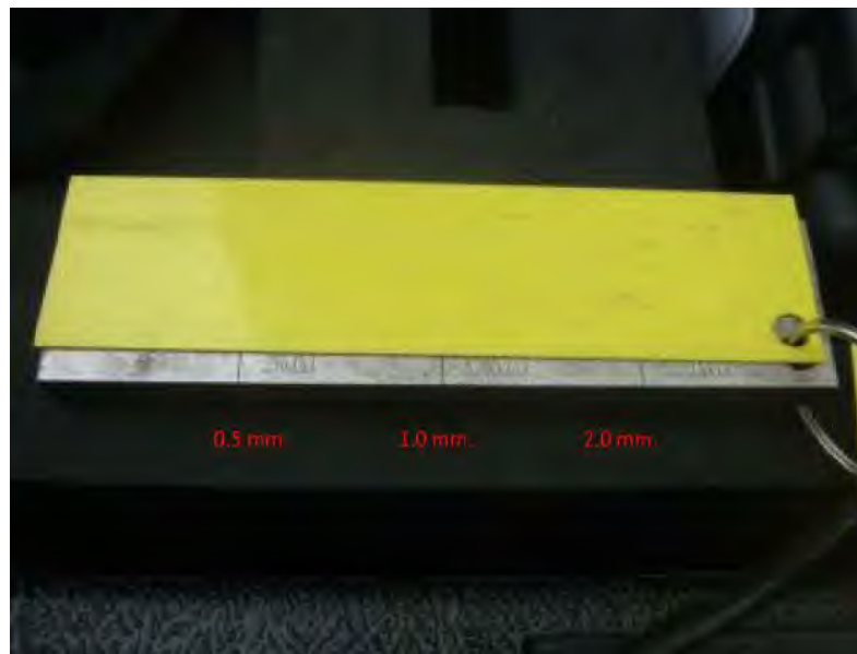
(ก) แท่งการิเบต (Calibration Block) และแผ่นเคลือบวัสดุ
