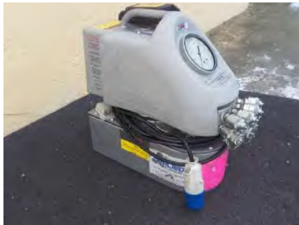
รูปที่ 4.3-1 เครื่อง Electric Pump รุ่น Hytorc QAS-230
