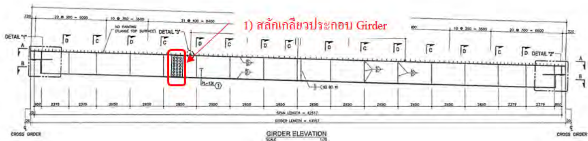
รูปที่ 2.4-5 ตัวอย่างแบบรอยต่อคานสะพานแบบสลักเกลียว
