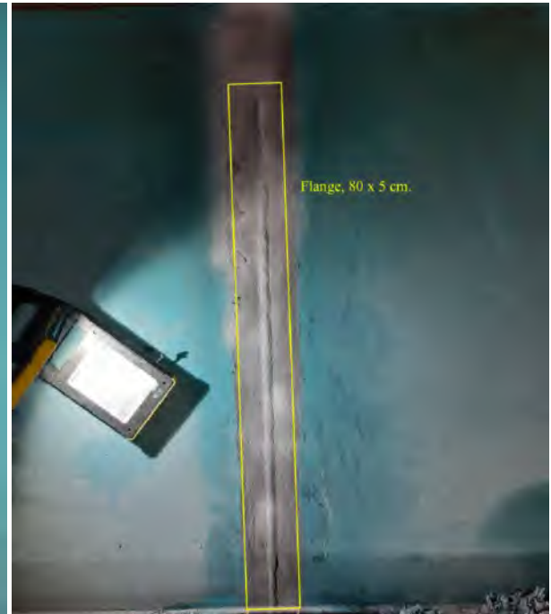
(ข) การตรวจสอบด้วยวิธี Magnetic Particle (ไม่พบรอยแตก)
