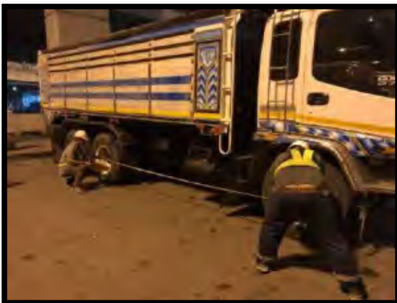
รูปที่ 5.7-4 ภาพการวัดมิติของรถบรรทุก
