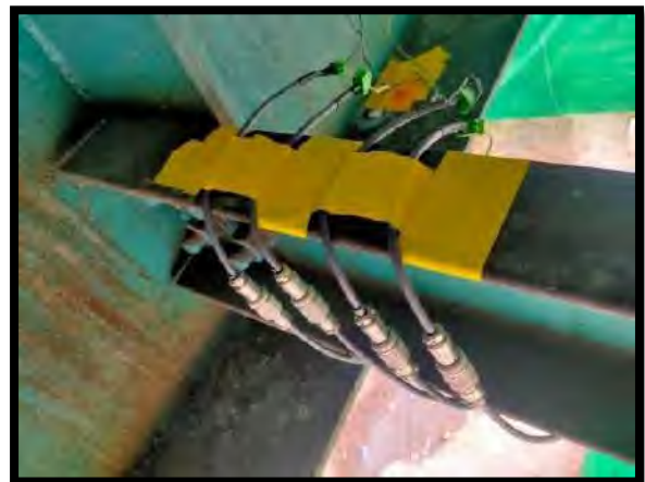
รูปที่ 5.7-3 ภาพการติดตั้งอุปกรณ์ตรวจวัดสะพานตัวที่ 1 (Flyover 1)
