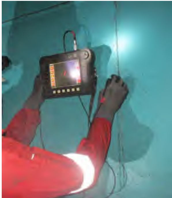
(ก) การตรวจสอบด้วยวิธี Eddy Current (ไม่พบรอยแตก)
