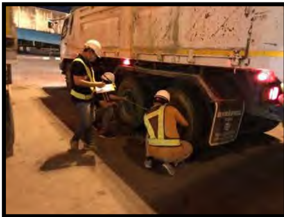
รูปที่ 5.9-5 ภาพการวัดมิติของรถบรรทุก
