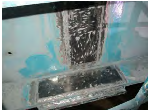
(ข) หลังลอกสี ทาน้ำยา และโรยผงแม่เหล็ก
