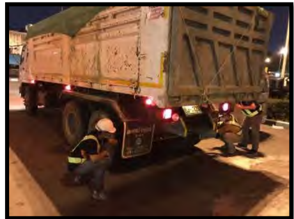
รูปที่ 5.9-5 ภาพการวัดมิติของรถบรรทุก
